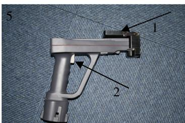
f) Je recommence l'essai, mais je retire l'analyseur du mur une fois que j'ai lancé la mesure, je dois entendre le « CLAC » signe de la rentrée de la source. Cette manipulation me permet de vérifier le fonctionnement des cellules photoélectriques fig3.
