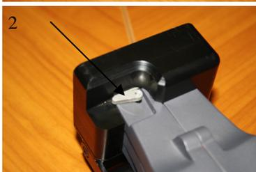
a) Appareil en mains, non posé contre un mur, je relève le volet de protection du diffuseur fig5.1. J'essaie de faire une mesure, rien ne doit se produire.
